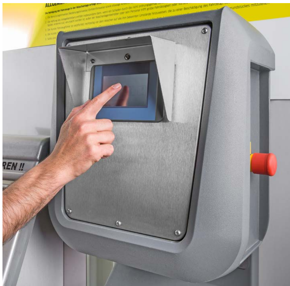
Le nouveau système de démarrage et de commande CR 214 pour les portiques de lavage a été spécialement développé par Kärcher. Un écran couleur sur l'installation guide le client dans le programme.
